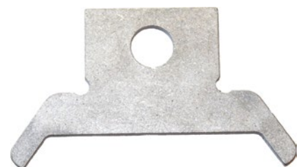
Rys. 4. Przedmiot stalowy po obróbce wibrościernej – przygotowany do malowania.
