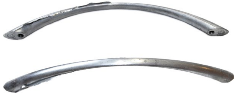
Rys. 2. Odlew żaluzowy z widocznymi zadziorami i ostrymi krawędziami przed obróbką.
