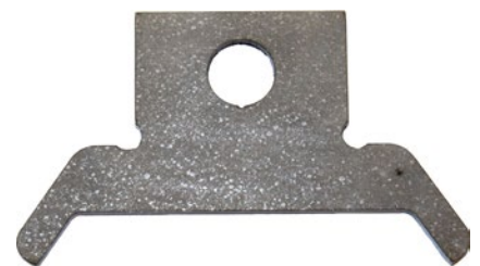
Rys. 3. Przedmiot stalowy po wycinaniu z widoczną zgorzeliną, ostrymi krawędziami i pozostałościami środków smarnych.
