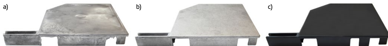
Rys. 7. Odlewy aluminiowe: a) przed obróbką, b) po obróbce, c) po malowaniu.
